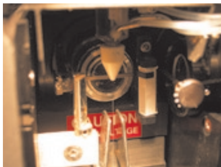
Flujo de 70 micras por donde circulan los núcleos que son analizados por el citómetro.
